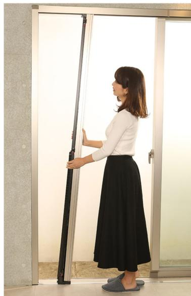
縦枠内に隠れている上部、中央、下部にある外れ止め部品をスライドすることで網戸本体の着脱が簡単に行え、施工性・メンテナンス性が向上
