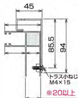
※シャッター枠中空部の寸法が小さい場合、ターンナットが回転できず使用できません
