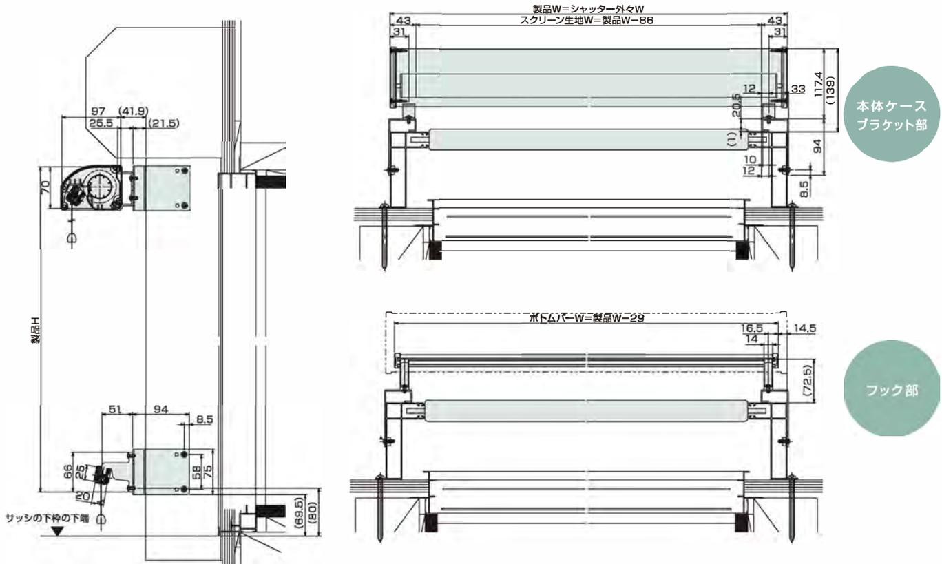
● シャッター付金具 固定方法選択条件（シャッターのアルミ材の厚みにより異なります。）
