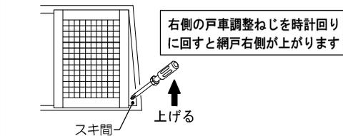
右側の戸車調整ねじを時計回りに回すと網戸右側が上がります
