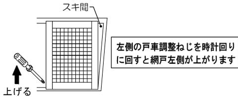
左側の戸車調整ねじを時計回りに回すと網戸左側が上がります
